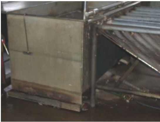
ภาพที่ 33 เครื่องลวกซากที่ผลิตในไทย (เตาตั้ง) โดย ใช้แก๊สเป็นเชื้อเพลิง
